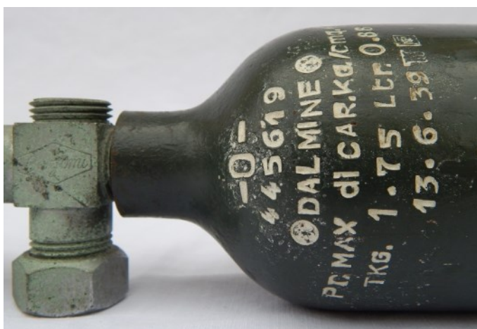
Fig. 20 - La bombola metallica contenente l'ossigeno compresso con annesso riduttore di pressione.
