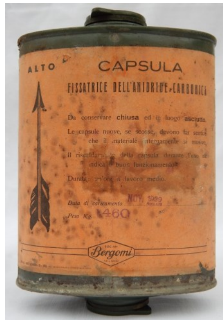
Fig. 23 - La capsula metallica, contenente soda caustica assorbente l'anidride carbonica e il vapore acqueo emessi nella respirazione, di colore verde con etichetta di carta a tutto corpo, arancione, con le indicazioni di massima e la data di caricamento: novembre 1939;
