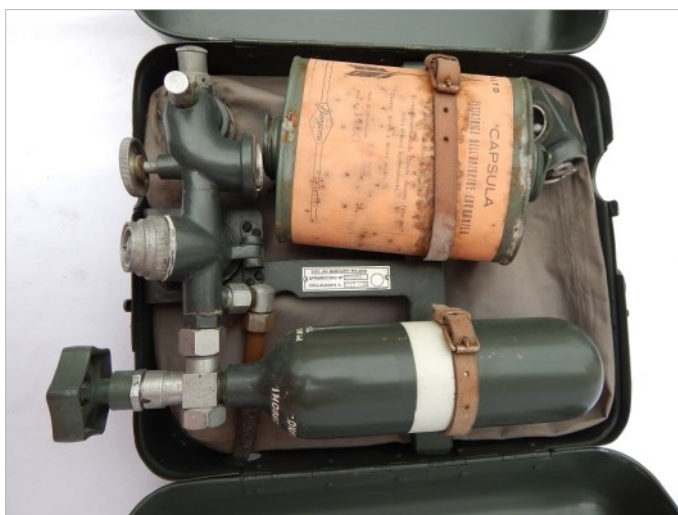
Fig. 19 - L'Autoprotettore Bergomi TIPO R. I. 1H N° 09252 è stato rinvenuto in una cassa ed è del tipo a riserva d'ossigeno.
