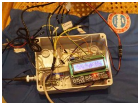
Conduttimetro da campo (Opera di Luca Tringali (JKKK)).
