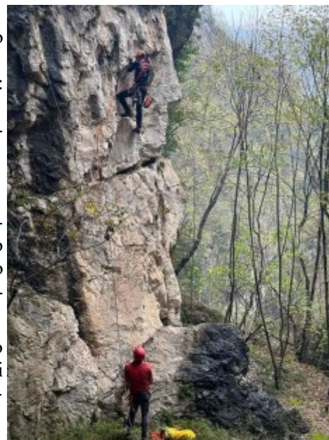
Test con prova tenuta ancoraggio su volo a cura di Alberto Carollo - Assistente Matteo Scapin (Foto Ernes Bonora).
