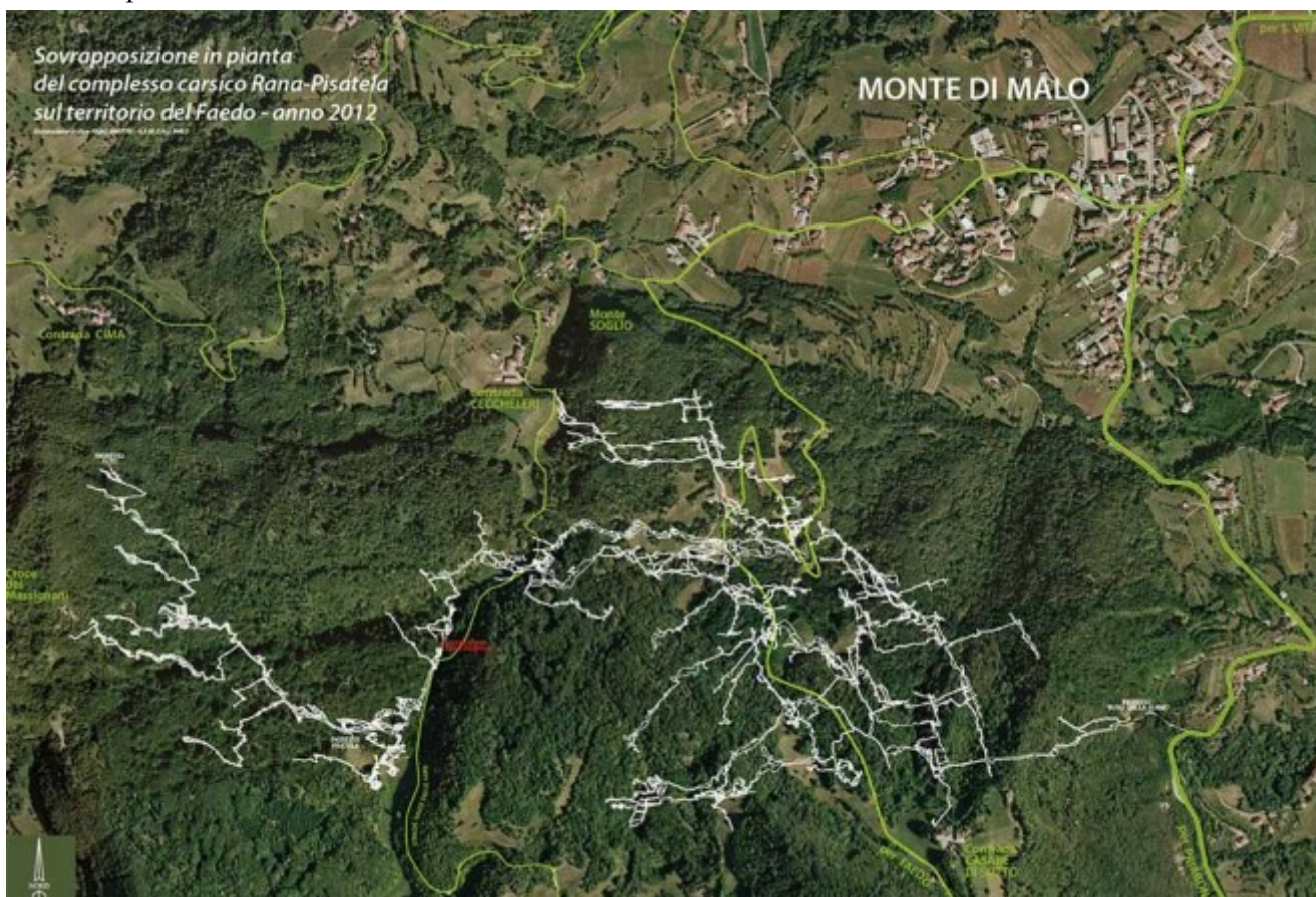
In questa ortofoto si può vedere lo sviluppo in pianta del rilievo topografico delle due grotte Rana e Pisatela sovrapposto al terreno dell'Altopiano del Faedo.
