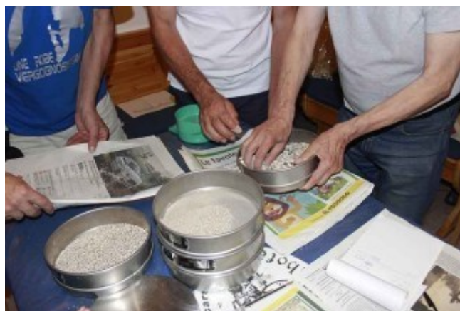
Гориция, филиал «Сеппенхофер». Затем гравий и песок просеиваются через сита.
