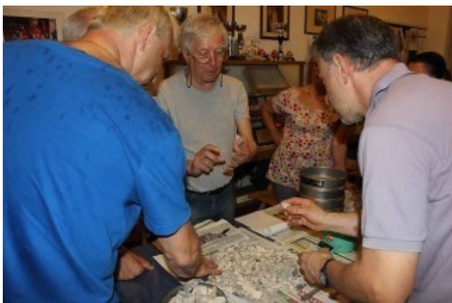
Гориция, филиал «Сеппенхофер». Сначала проводится визуальное отделение более крупных гравийных зерен.
