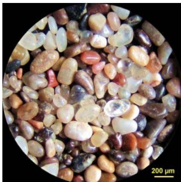
Рис. 3 — В данном случае были отделены только зерна с полированными поверхностями. Все они состоят из кремня и некоторых разновидностей кварца. Эксперименты Кюнена (1959) показали, что потеря веса песка с угловатыми зернами кварца не превышает 1 % после переноса на расстояние 20 000 км (Bosellini et al. 1989). Как правило, пески с такими округлыми и гладкими зернами происходят из отдаленных мест и претерпели больше осадочных циклов. В данном случае они образовались в результате размывания флиша, поэтому, по всей вероятности, осадочные циклы начались еще до образования этих литотипов и продолжались вплоть до наших дней.
