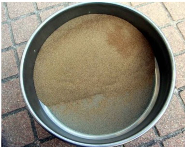
Рис. 2 — Сито, используемое для гранулометрического исследования песков, собранных в пещере «Норма Коссетто» 5410/5906VG (исследование опубликовано в журнале «TuttoCat», 2015 год).
