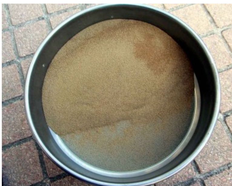
Fig. 2 - Setaccio usato per lo studio granulometrico di sabbie raccolte nella grotta “Norma Cossetto” 5410/5906VG (Studio pubblicato su TuttoCat, anno 2015).
