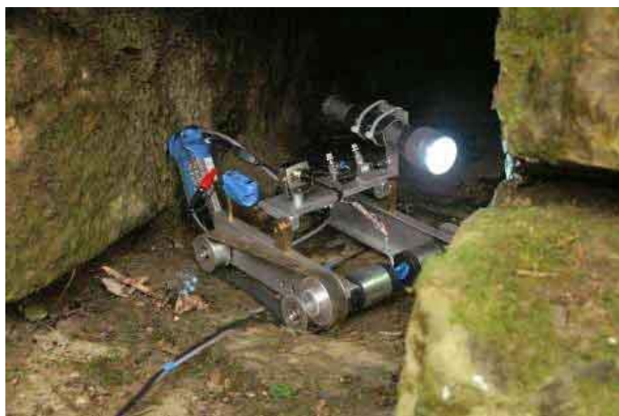
Fig. 84 - Ogni anfratto o possibile accesso a delle gallerie è stato minuziosamente esplorato attraverso questo piccolo robot (autocostruito dal "Seppenhofen") collegato ad un video.
