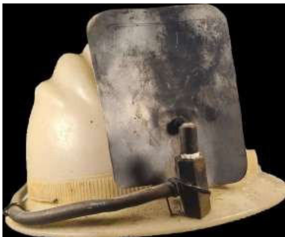
1967/68 год. На этих прекрасных фотографиях, предоставленных Роберто Тодаро, можно увидеть два старых шлема с самодельной карбидной установкой. На первом, установленном на строительном шлеме, устройство ещё очень грубое и примитивное. На втором, уже более совершенном, устройство закреплено на альпинистском шлеме, а круглое зеркало изготовлено из дна баллончика с газовым топливом для кемпинга.
