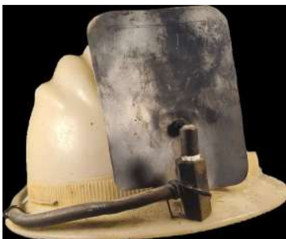
Anno 1967/68. In queste belle immagini fornite da Roberto Todaro si possono vedere due vecchi caschi con impianti a carburo autocostituiti. Nel primo, sistemato su casco da cantiere, l'impianto è ancora molto grezzo e rudimentale. Nel secondo, già più evoluto, l'impinto è fissato su un casco di tipo alpinistico, lo specchio rotondo è realizzato con il fondo di una bomboletta camping gaz.
