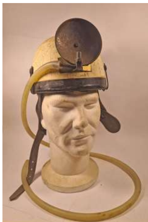
Anno 1967/68. In queste belle immagini fornite da Roberto Todaro si possono vedere due vecchi caschi con impianti a carburo autocostituiti. Nel primo, sistemato su casco da cantiere, l'impianto è ancora molto grezzo e rudimentale. Nel secondo, già più evoluto, l'impinto è fissato su un casco di tipo alpinistico, lo specchio rotondo è realizzato con il fondo di una bomboletta camping gaz.
