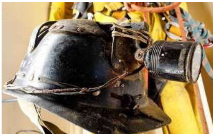
Еще один шлем английского типа с прикрепленным к передней части неудобным и весьма примитивным электрическим устройством.
