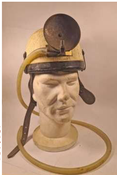
1967/68 год. На этих прекрасных фотографиях, предоставленных Роберто Тодаро, можно увидеть два старых шлема с самодельной карбидной установкой. На первом, установленном на строительном шлеме, устройство ещё очень грубое и примитивное. На втором, уже более совершенном, устройство закреплено на альпинистском шлеме, а круглое зеркало изготовлено из дна баллончика с газовым топливом для кемпинга.
