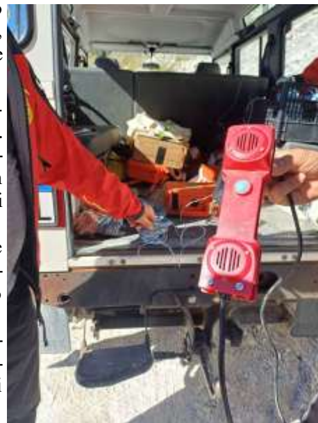
Il sistema telefonico utilizzato in grotta e il doppino per le comunicazioni (foto M. Abisso).
